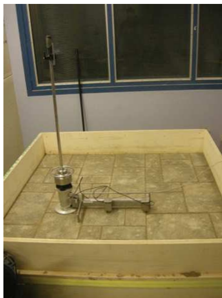
Figure 12. Exemple d'un essai de chargement dynamique au moyen d'un LFWD
