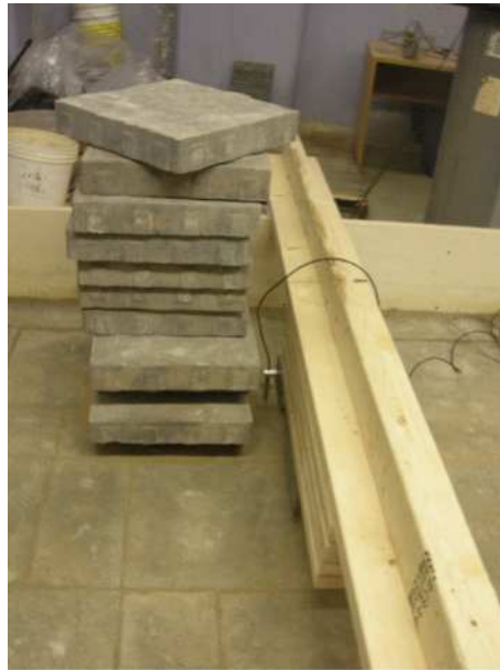
Figure 11. Exemple de la mesure du bassin de déflexion pour un chargement statique
